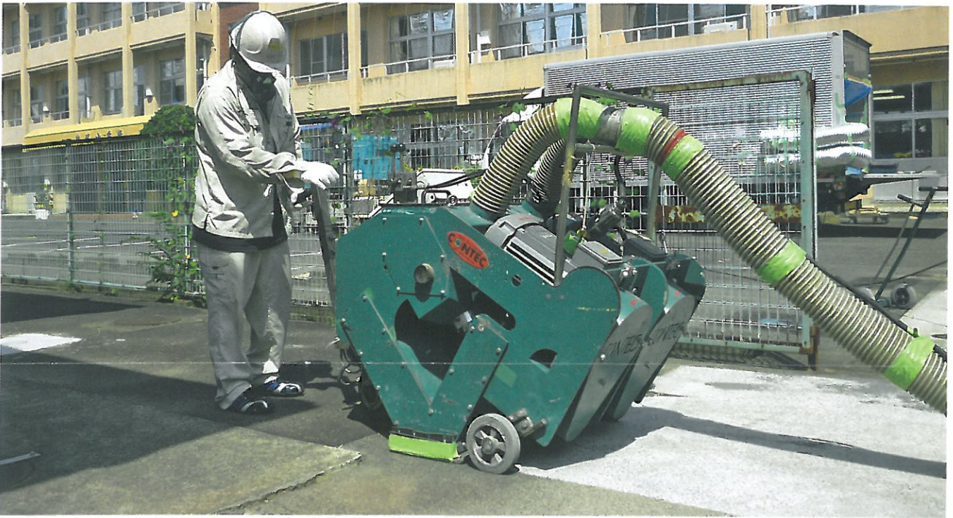
DIN Patronen und Schwebstofffilter SF 13 K sorgen in der Kugelstrahlanlage von Contec für die zuverlässige Filtration von radioaktivem Staub
